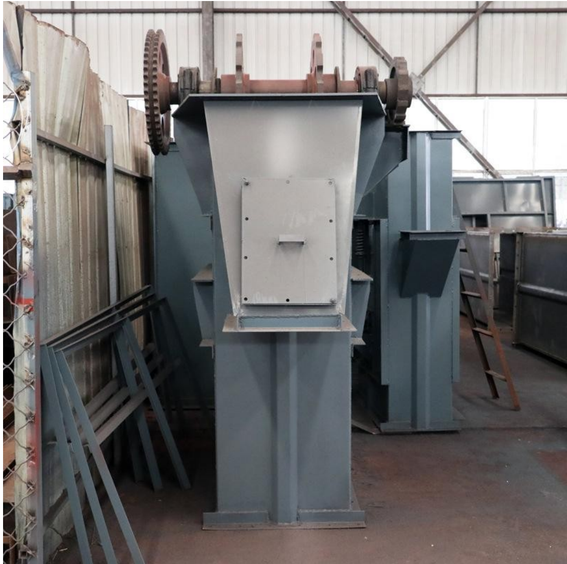
图 1-1 NE 型板链斗式提升机整机外观
